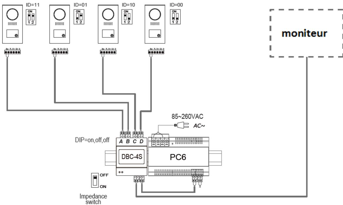
Vous avez également un dip-switch sous le contrôleur qui sert à définir avec quelle gamme de produit il va être utiliser.
