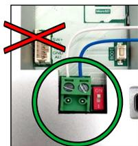
Ne pas connecter l'alim. KPC9 à la terre "T"
