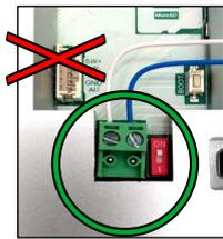
Ne pas connecter l'alim. KPC9 à la terre "T"
