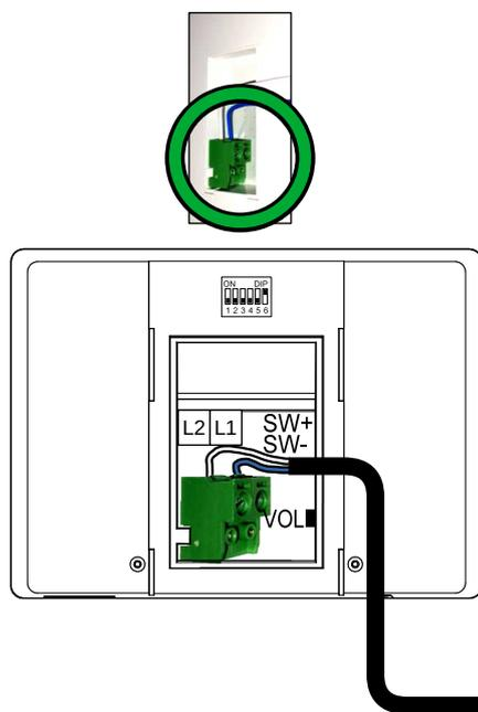
Ne pas connecter l'alim. KPC9 à la terre "T" sauf si le courant électrique est parasité (vidéo parasitée...)
