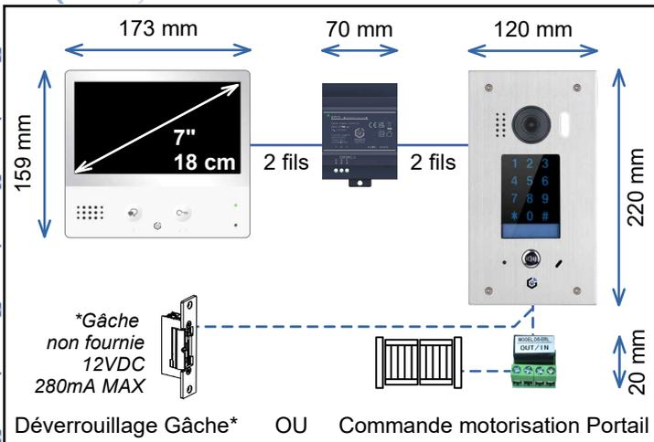
Pour Déverrouillage Gâche ET Commande motorisation Portail : **Mini-RLC-C** en option
