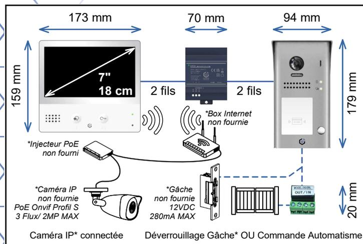
Pour Déverrouillage Gâche ET Commande Automatisation : Mini-RLC-C en option
