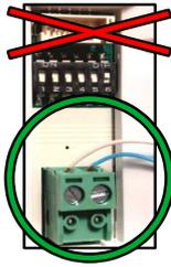
**Ne pas connecter l'alim. KPC9 à la terre "T"
