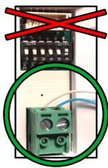
Ne pas connecter l'alim. KPC9 à la terre "T"
