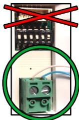
Ne pas connecter l'alim. KPC9 à la terre "T"
