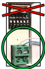
Ne pas connecter l'alim. KPC9 à la terre "T"
