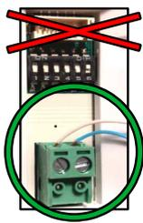
Ne pas connecter l'alim. KPC9 à la terre "T"
