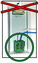
**Ne pas connecter l'alim. KPC9 à la terre "T"
