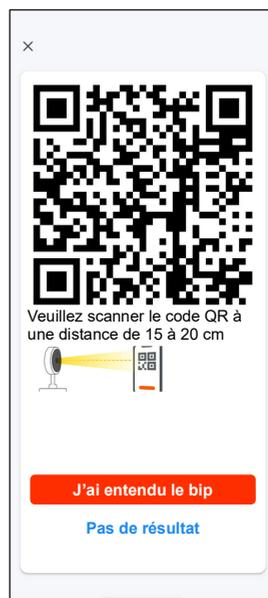
Lors du scan du QR Code par la caméra, déplacer lentement votre smartphone devant l'objectif de la caméra, d'avant en arrière à une distance de 15 à 20 cm.
