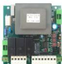
**GCTR44** armoire de commande pour 1 moteur 230v
