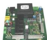
**GCTR54** armoire de commande pour 1 ou 2 moteurs 230v avec ralentissement
