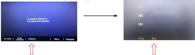
**6.4) "Menu"** Vous avez un "Menu" caché qui permet pas mal de réglages, pour y accéder pressez "Menu" puis "Déverrouiller 1" (clé) jusqu'à ce qu'apparaisse le menu caché avec :
