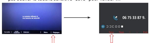
**6.3) "Intercom"** Vous pouvez utiliser la fonction "Intercom" en appuyant sur "Intercom" puis sur les flèches haut et bas afin de choisir le numéro du poste et pressez "Dial"\_\_\_\_\_\_
