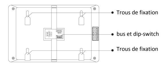
Vissez directement les vis Sur la boite encastrée au mur, si ce n'est pas le cas utilisez une scie cloche, car les trous oblong correspondent aux deux trous horizontaux de la plaque de fixation du moniteur.
